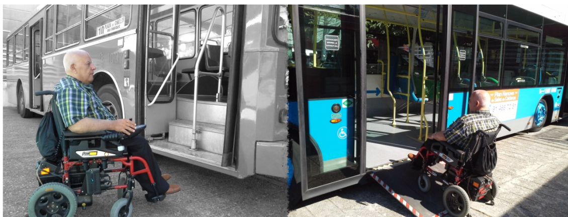
Acceso al autobús urbano antiguo y actual
